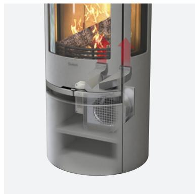
**Ventilator** Giver hurtig fordeling af varmen og mere ensartet temperatur. Termostatstyret. Den starter automatisk, når du fyrer, og standser, når ilden er gået ud. Nem at montere, selv efterfølgende.
